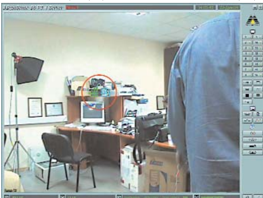
Красным кругом мы выделили работу детектора движения SDD: достаточно передвинуть даже очень мелкий объект и зеленым цветом будет отмечено исчезновение объекта, а появление нового объекта - синим. Постоянное движение в кадре и перекрытие объектов не влияют на работу детектора SDD.
