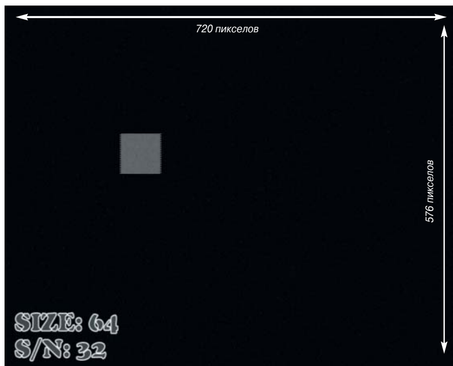
Кадр из тестового клипа. (720x576 пикселей, ч/б, 25 к/с, 256 уровней яркости, поток AVI без сжатия.)
